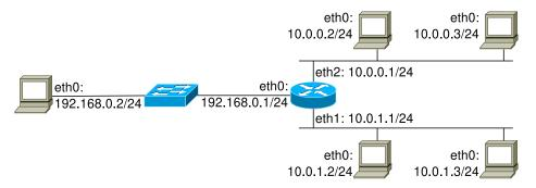
Abb. 1.2: Drei Ethernet-LANs, verbunden durch einen Router
