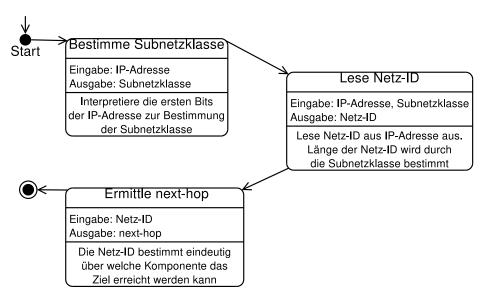
Abb. 1.6: Schematische Darstellung eines Automaten zur Wegewahl
